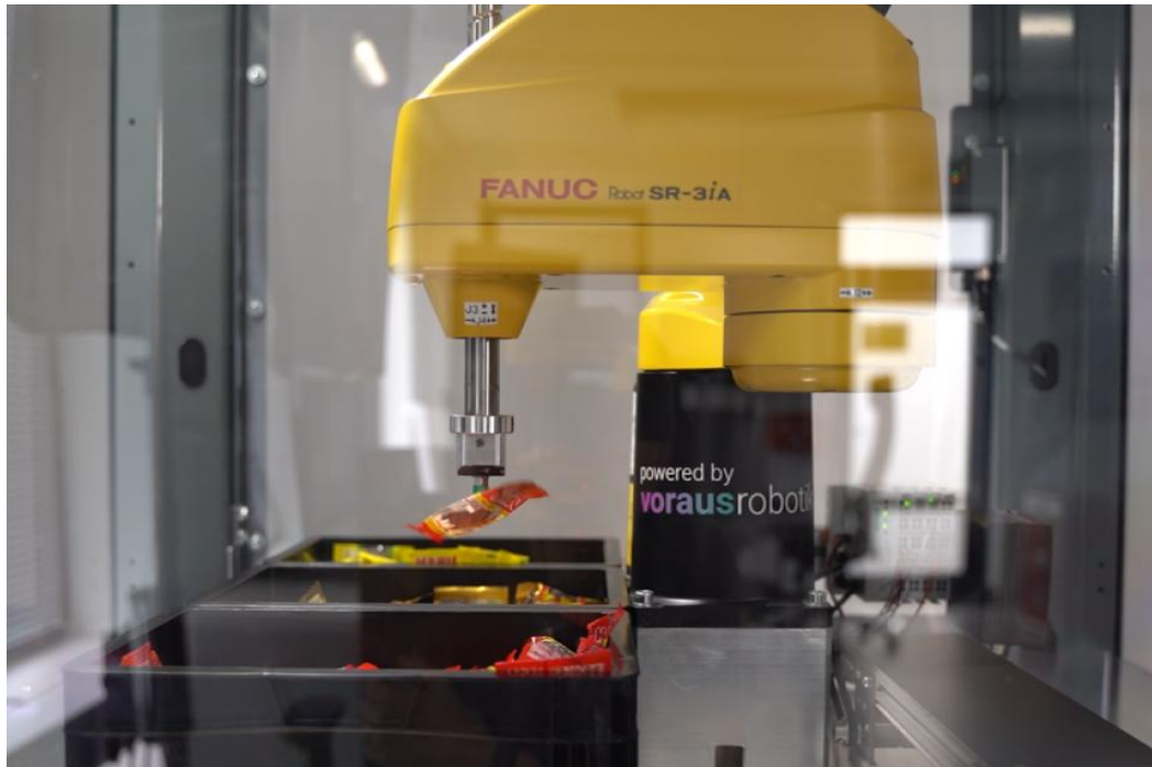
Bild 4: Pick-&-Place-Zelle mit Roboter, Förderband, drei Kisten und Sauggreifer
