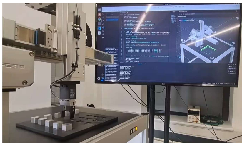
Bild 14: Individuelle Kinematik inklusive automatisiert getesteter Steuerungscode – reale Anlage und Simulation
